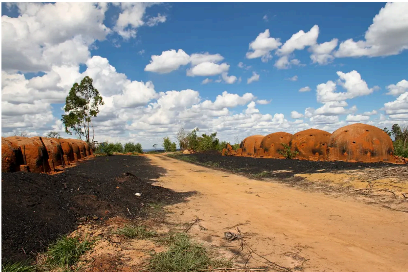
Fornos de eucalipto para a produção de carvão no Brasil | Foto: Robson Valadares/Shutterstock
